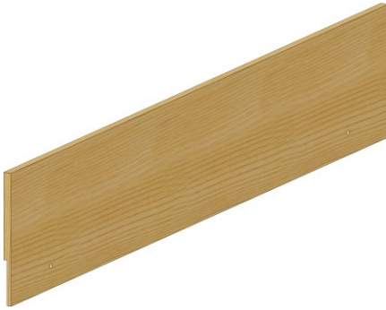
Figura 3.32 – Sanca para placas de revestimento interior
