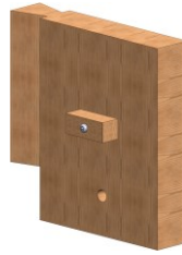
Figura 4.24 – Ligação viga da cobertura – placa superior das paredes laterais
