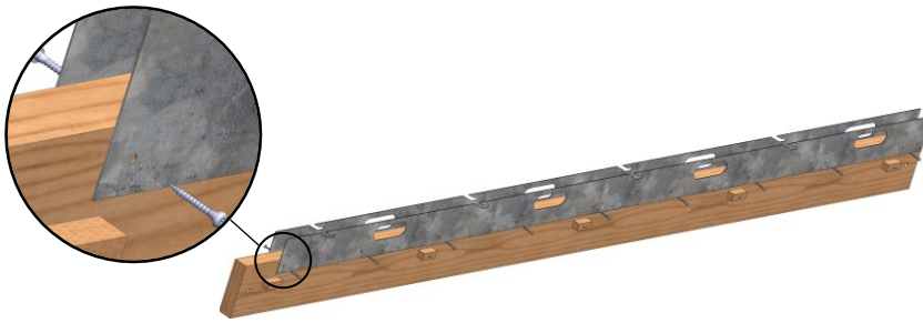
Figura 4.18 - Montante com duas régua (esquerda e direita) pré-montadas pela fixação com parafusos CSA Ø5.0 x 35mm
