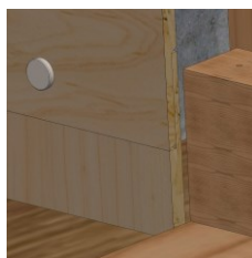
Figura 4.30 - Fixação dos rodapés às placas junto ao piso
