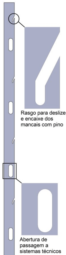
Figura 3.31 – Régua para encaixe das placas de revestimento interior e passagem de sistemas
