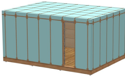
Figura 4.33 - Colocação das placas de isolamento térmico XPS nas paredes e cobertura
