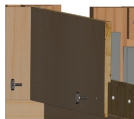
Figura 4.31 - Fixação das sancas às placas junto ao teto
