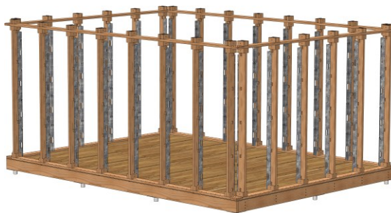
Figura 4.22 - Finalização da montagem dos montantes
