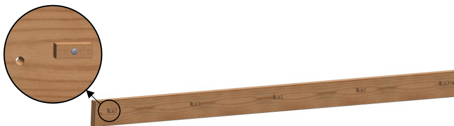
Figura 4.17 - Montante pré-perfurado para fixação por pino cilíndrico, e aparafusado com apoios para placas de isolamento XPS
