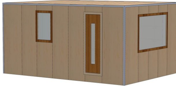
Figura 3.15 - Parede longitudinal contendo porta e janela pequena (comprimento do módulo), e parede lateral contendo janela grande (largura do módulo)
