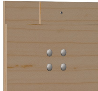
Figura 3.29 - Vista da face visível das placas, após rebitagem e inserção das porcas de garra
