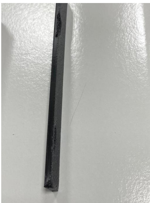
Figura 35 - Anomalia no provete de ensaio
