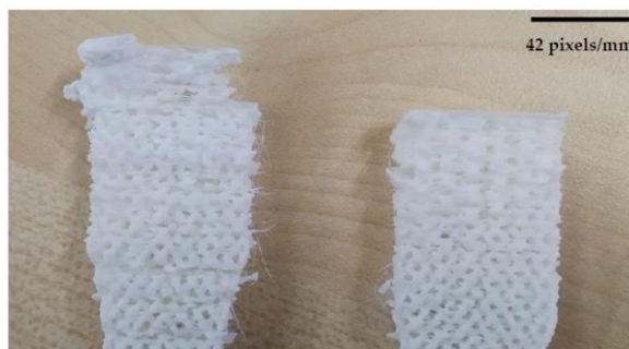
Figura 22 - Deformações visíveis na impressão a 75° (18).
