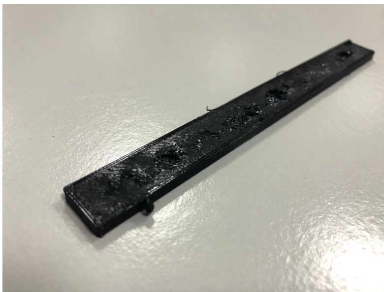
Figura 37 - Falha total provete 0% densidade de infill
