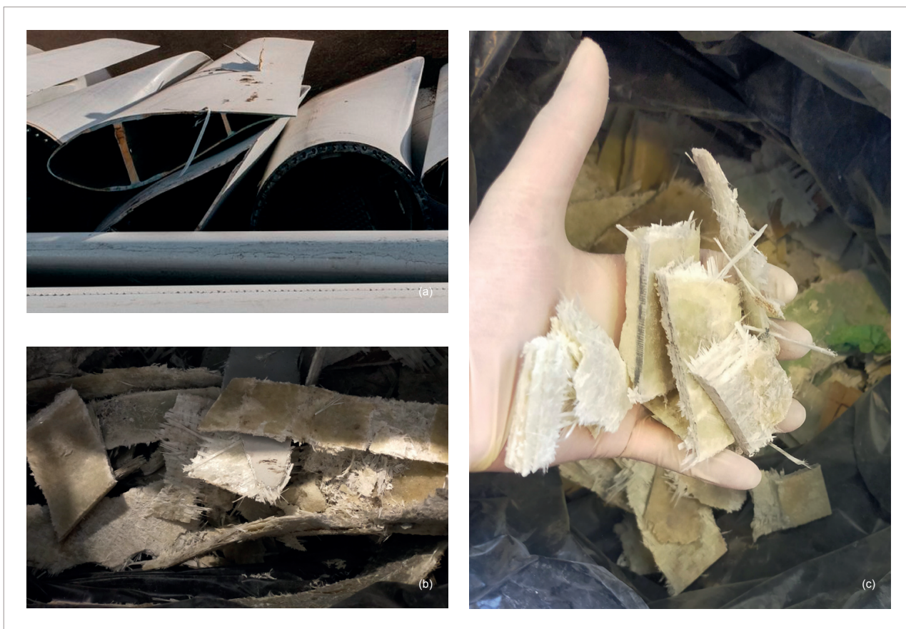
Figura 1. Resíduo de pás eólicas desativas: a) resíduo inteiro, b) resíduo em forma de tiras e c) resíduo fragmentado em pedaços
